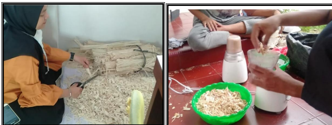
Gambar 2. Proses pemotongan dan penghalusan serat tebu
