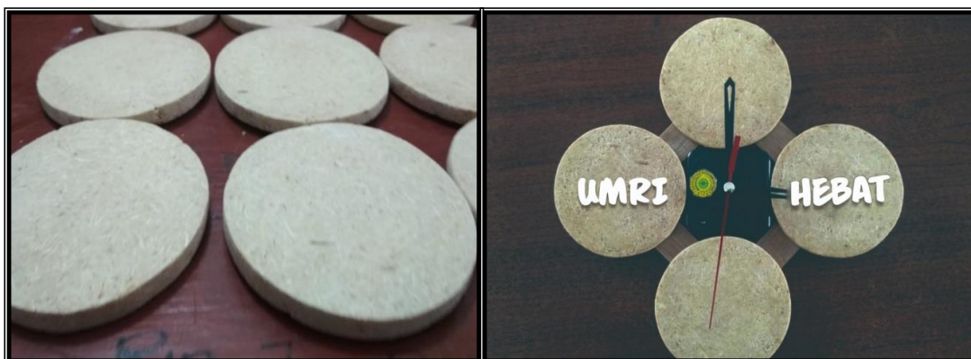
Gambar 4. Papan Partikel yang sudah dihaluskan dan salah satu desain jam serat tebu
