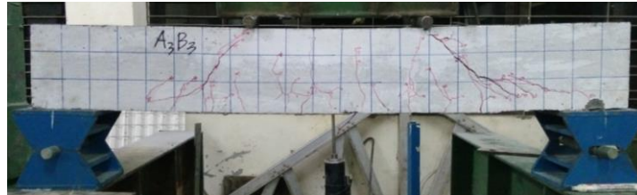
Gambar 9. Pola retak balok beton bertulang bambu (BRC)
