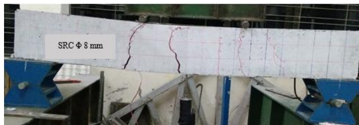
Gambar 10. Pola retak balok beton bertulang baja (SRC)
