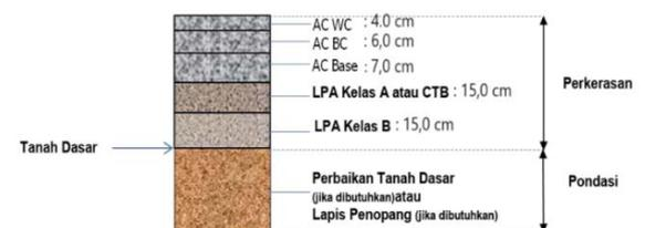
**Gambar 5.** Struktur Perkerasan Lentur (Flexible Pavement) dengan tebal 47 cm
