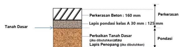
**Gambar .** Struktur Perkerasan Kaku (Rigid Pavement) dengan tebal 28,5 cm
