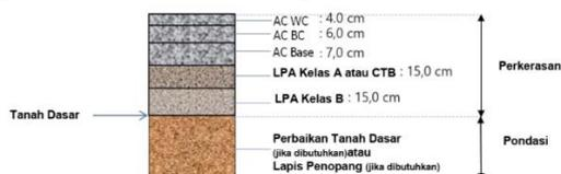
**Gambar 3.** Struktur Perkerasan Lentur (Flexible Pavement) dengan tebal 47 cm
