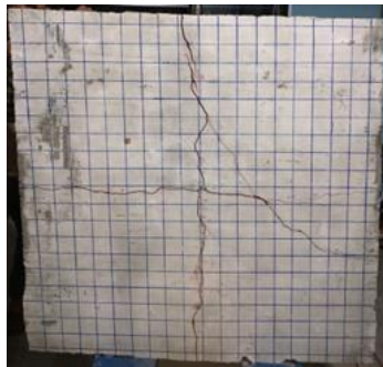
Gambar 25 Pola Retak Plat Ukuran 100 Sumber : Eksperimen, 2022
