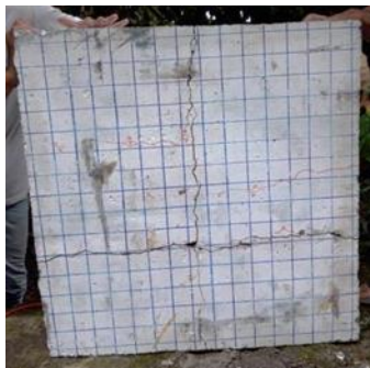
Gambar 24 Pola Retak Plat Ukuran 80 Sumber : Eksperimen, 2022
