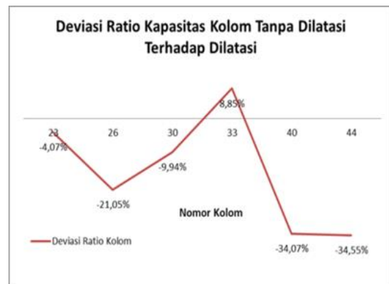
Gambar 10. Grafik Deviasi Ratio Kapasitas Kolom dengan Dilatasi dan Tanpa Dilatasi Sumber : Hasil Perhitungan, 2022
