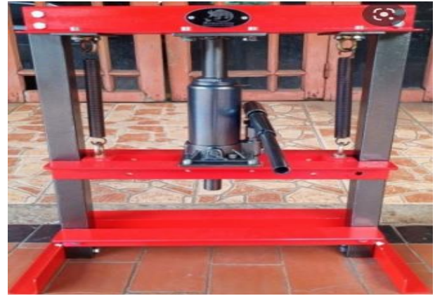
Gambar 3. Penekanan brake pads setelah di cetak
