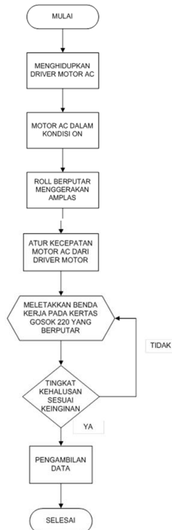
Gambar 5. Diagram Alir Proses Kerja Mesin
