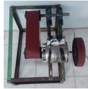
Gambar 7. Tampilan Mesin Penghalus Tipe Disc dan Belt
