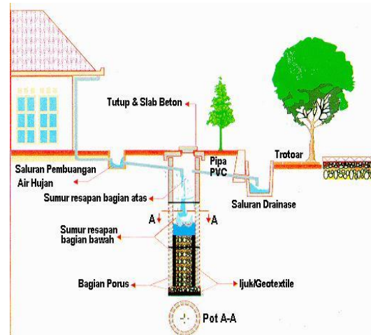
Gambar 1. Contoh pot A-A sumur resapan pada perumahan
