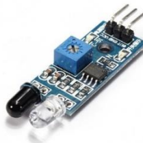
Gambar 3. Module sensor inframerah
