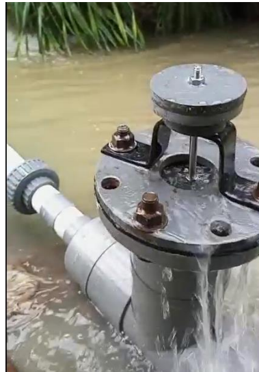
Gambar 10 Pengujian pompa hidram di sungai Desa Pakistaji
