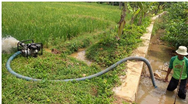
Gambar 1 Proses pemompaan air ke lahan pertanian (Surya,2015)
